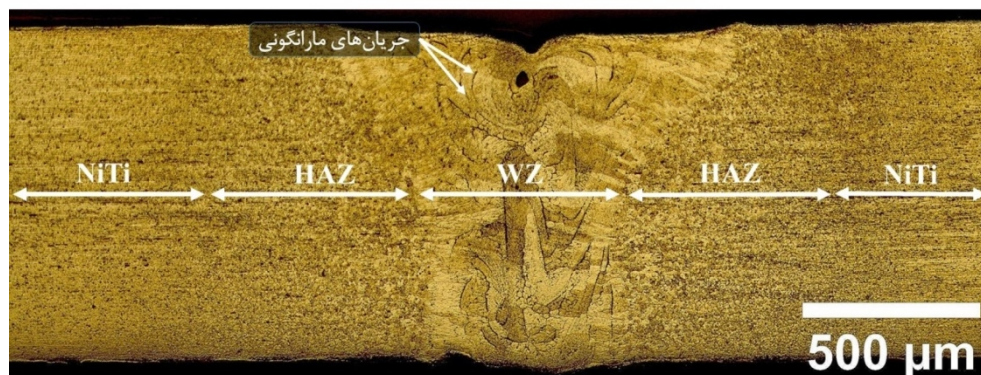
شکل 2- تصویر میکروسکوپ نوری از ریزساختار اتصال با مدت زمان اعمال پالس 8 میلی‌ثانیه.
