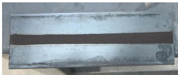
شکل 1- نمونه آماده سازی با پودر CuO.
