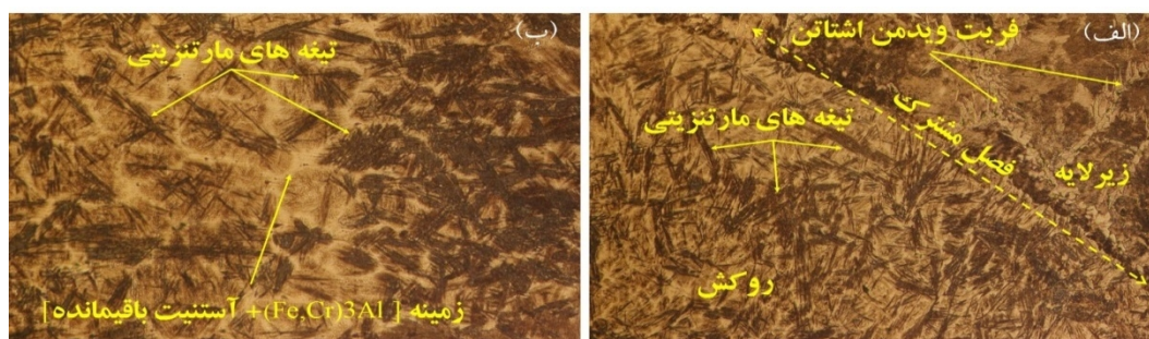
شکل 8- ریزساختار لایه روکش \text{Fe}_3\text{Al} (الف) ریزساختار فصل مشترک روکش/ زیرلایه و (ب) ریزساختار لایه روکش (\text{Fe,Cr})_3\text{Al}
