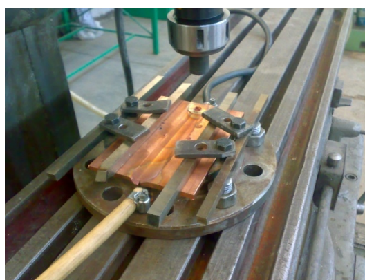
شکل 1- قالب جوشکاری مجهز به سیستم خنک کننده.
