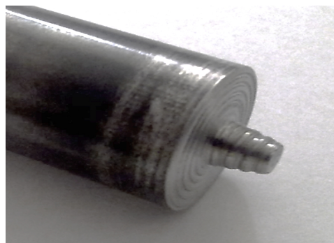
شکل ۲- ابزار طراحی شده جهت جوشکاری اصطکاکی اغتشاشی
