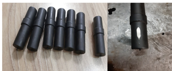
شکل 1- ابزارهای سخت‌کاری شده (52 راکول سی).
