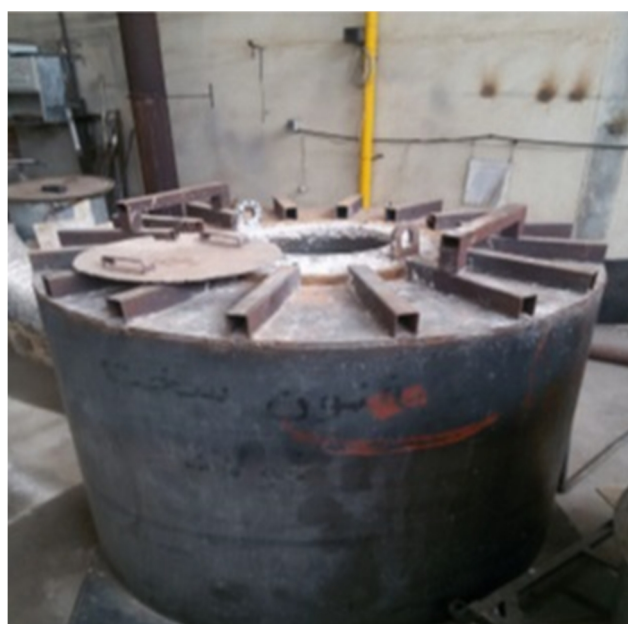
شکل 4- کوره عملیات حرارتی کربوره کردن
