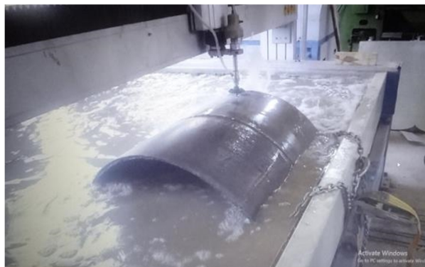
شکل 2- برش لوله توسط واتر جت
