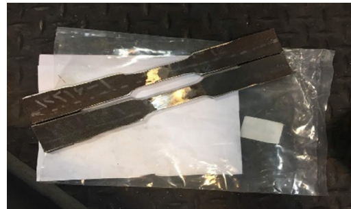
شکل 4- نمونه قطعه آماده شده برای آزمایش کشش.
