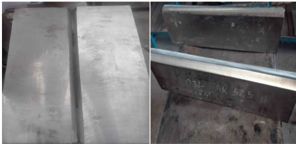
شکل 2- نمونه آلیاژ SA516-GR60 قبل و بعد از کلدینگ با SA240-TP316.
