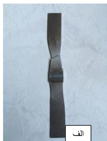
شکل ۶-الف) تصویر شکست نمونه جدا شده در راستای عمود بر خط جوش ب) نمودار نیرو- جابجایی نمونه‌های جدا شده در راستای عمود بر خط جوش.
