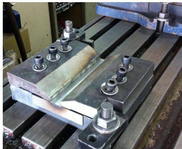
شکل ۲- فیکسچر مورد استفاده در آزمایشات تجربی جوشکاری اصطکاکی اختشاشی ورق های فولادی با ضخامت  $0/7$  میلیمتر
