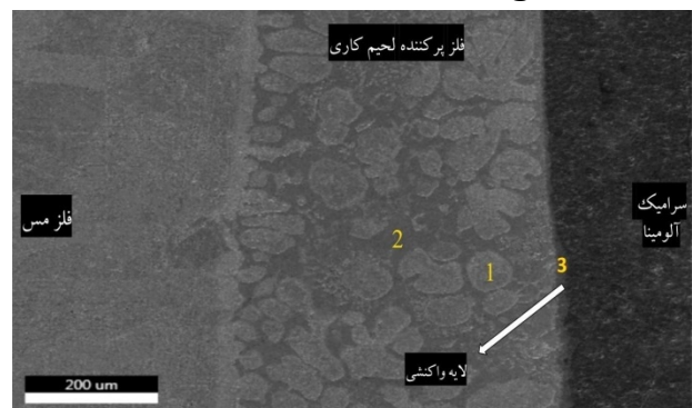
شکل 12- تصویر میکروسکوپی الکترونی روبشی از اتصال \text{Al}_2\text{O}_3/\text{Cu} با فلزپرکننده \text{Ag-Cu-Ti-Sn-3.5Zr} .
