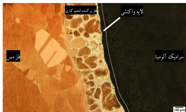
شکل 4- تصویر میکروسکوپی نوری اتصال لحیم کاری آلومینا به مس با فلز پرکننده Ag-Cu-Ti-Sn.
