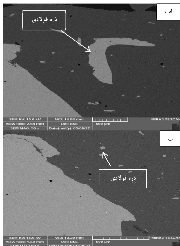
شکل 9- تصاویر میکروسکوپ الکترونی روبشی در حالت درشت ساختار: الف-سرعت پیشروی 60 mm/min و ب-سرعت پیشروی 125 mm/min.
