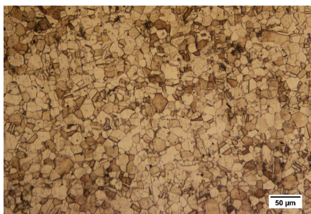
شکل 1- ریزساختار فولاد AISI 316L.
