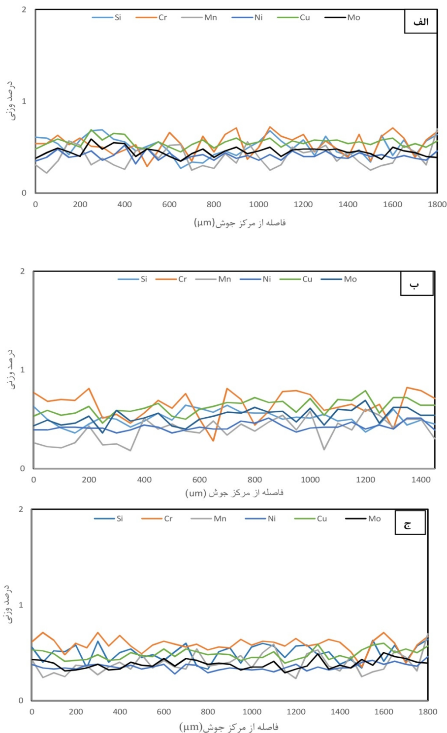
شکل 6- نتایج آنالیز EDS الف - نمونه LW10 ب - نمونه LW11 ج - نمونه LW12.
