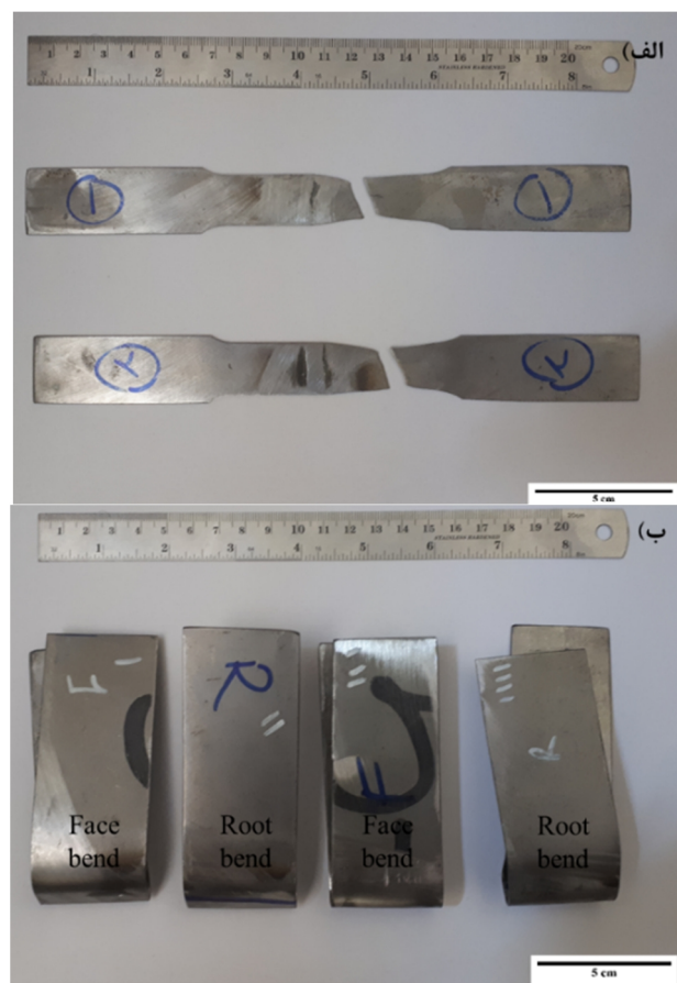
شکل 9- نمونه‌های اتصال غیرهمجنس بعد از الف - آزمون کشش ب - آزمون خمش ریشه و خمش گرده جوش.
