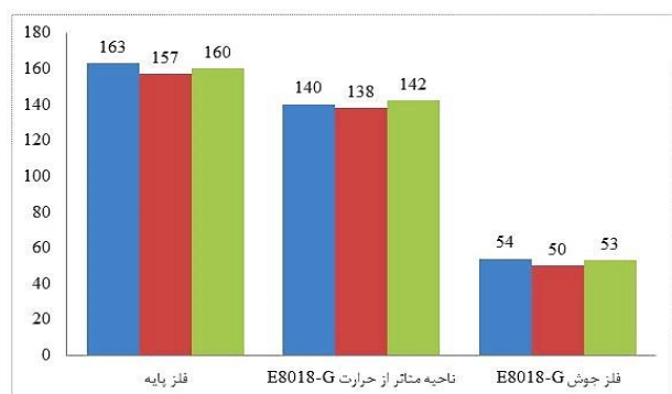
شکل 9- نتایج حاصل از آزمون ضربه شاری برای نواحی سه گانه حاصل از جوشکاری فولاد P460NH با الکتروود E8018-G
