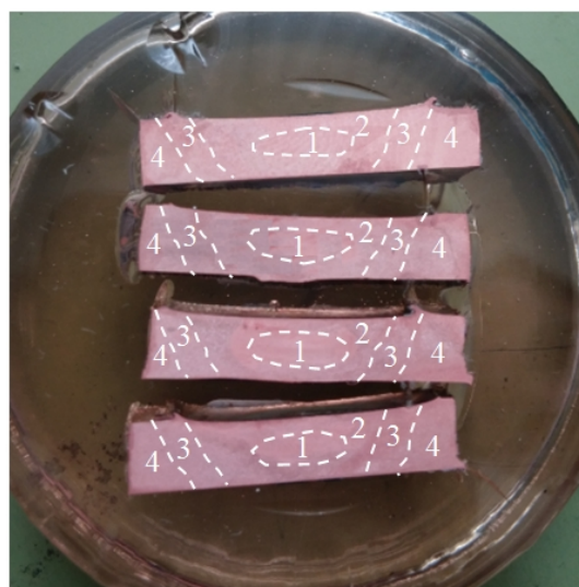
شکل 2- مناطق مختلف حاصل از انجام فرایند جوشکاری با شرایط مختلف جوشکاری، به ترتیب از بالا به پایین، W.C.1، W.C.2، W.C.3، و W.C.4. 1- ناحیه اغتشاشی، 2- ناحیه متأثر از عملیات ترمومکانیکی، 3- ناحیه متأثر از گرما و 4- ماده پایه).
