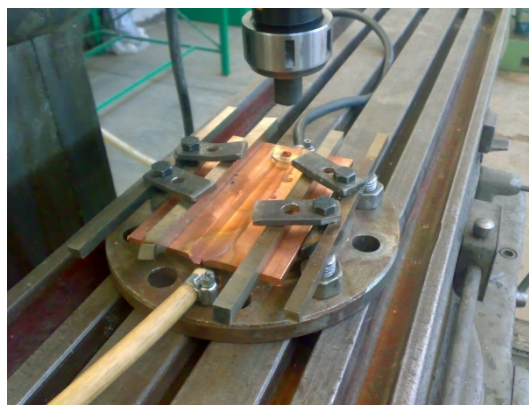
شکل 1- قالب جوشکاری مجهز به سیستم خنک کننده.
