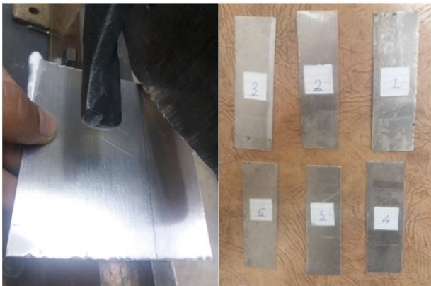
شکل 2- آماده سازی و برش کاری نمونه‌های شاهد
