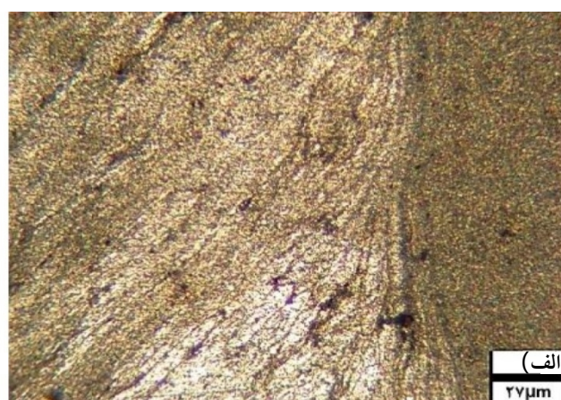
شکل 5- فصل مشترک ریزساختاری پاس‌های اول و دوم ورق آلیاژ آلومینیوم ریختگی فرآوری شده FSP. در بزرگنمایی‌های مختلف: الف) 50X، ب) 100X.
