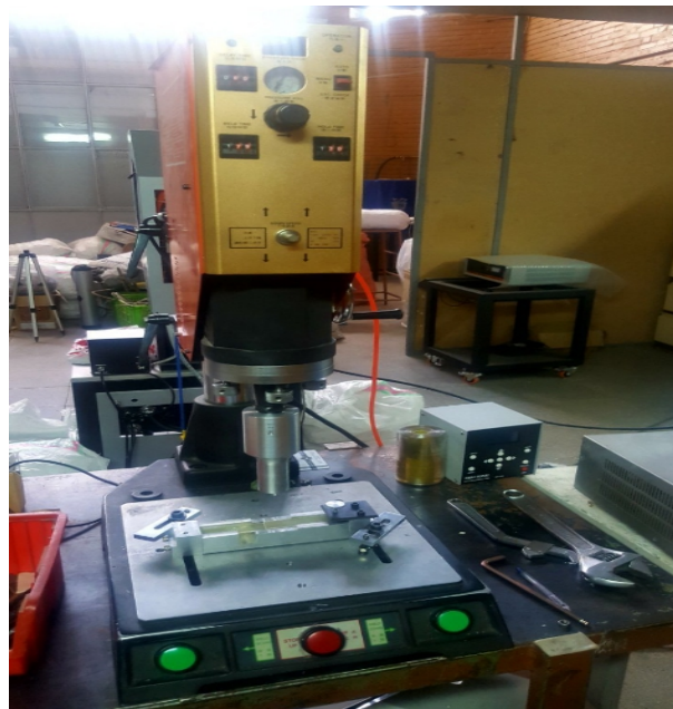
شکل 3- بدنه تغذیه دستگاه جوشکاری فراصوتی 2600 وات ساخت شرکت مکس واید
