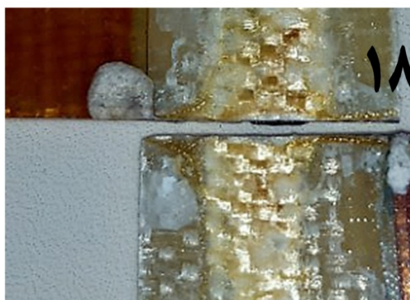
شکل 6- تصاویر نحوه شکست نمونه‌های 1 و 7 و 11 و 18
