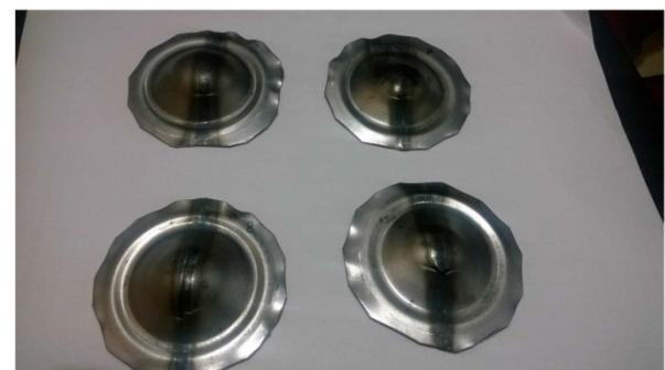
شکل ۳- نمونه‌هایی از ورق‌های ترکیبی شکل دهنده شده در قالب آزمون ارتفاع گنبد و پارگی‌های ایجاد شده بر روی آنها
