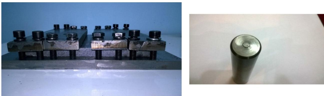
شکل ۱- تصویر فیکسچر و ابزار مورد استفاده جهت انجام فرآیند جوشکاری اصطکاکی اغتشاشی
