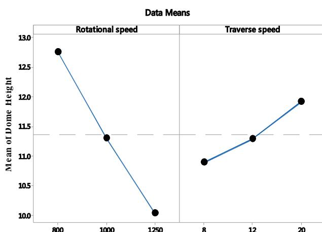
شکل 6- تاثیر سرعت دورانی و سرعت پیشروی در فرآیند جوشکاری اصطکاکی اغتشاشی بر ارتفاع شکل دهنده شده در تست ارتفاع گنبد ورق های ترکیبی جوشکاری شده
