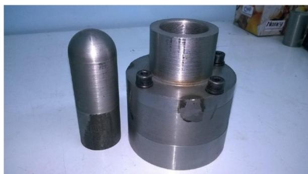
شکل ۲- قالب آزمون ارتفاع گنبد مورد استفاده در این تحقیق
