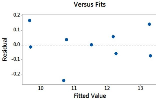
شکل ۵- نمودار مقادیر باقیمانده در برابر مقادیر برآشش شده در تحلیل آماری تست ارتفاع گنبد ورق‌های ترکیبی جوشکاری شده
