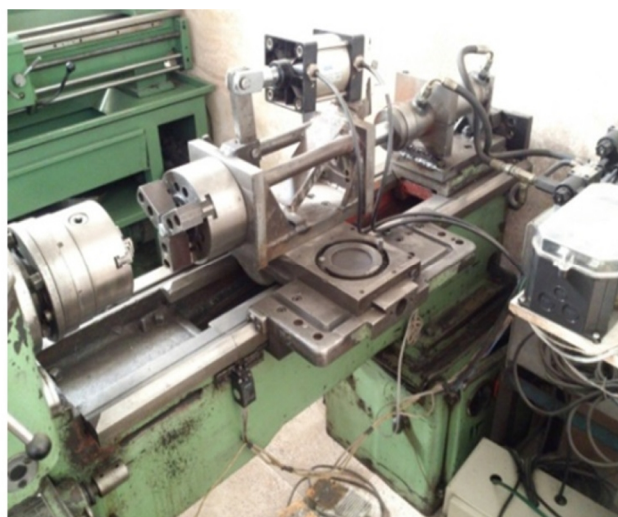
شکل 2- دستگاه جوش اصطکاکی چرخشی
