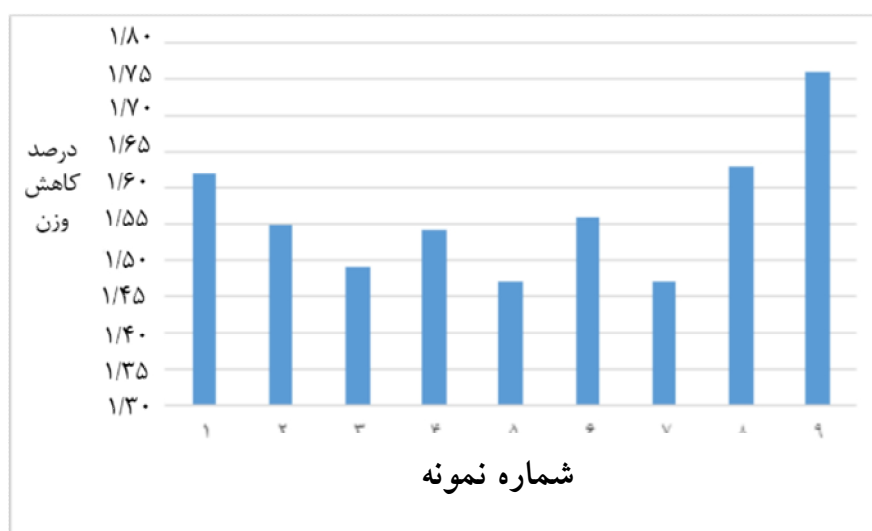
شکل 14- درصد کاهش وزن نمونه‌های اتصال‌یافته در دماها و زمان‌های مختلف.
