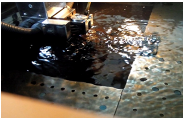
شکل 1- برشکاری با استفاده از دستگاه واترجت
