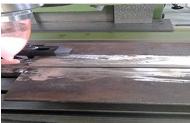
شکل 2- توزیع نانو مواد در طرح اتصال جوش
