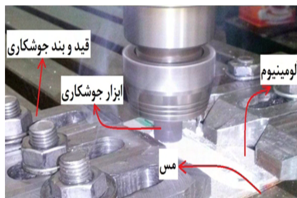
شکل ۱- تصویر فرایند جوشکاری اصطکاکی اغتشاشی
