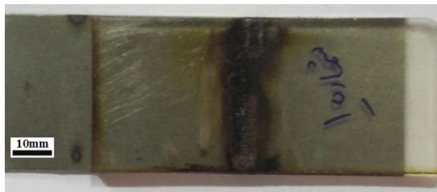
شکل ۶ - نمونه های جوشکاری St12 و پلی کربنات
