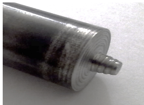
شکل ۲- ابزار طراحی شده جهت جوشکاری اصطکاکی اغتشاشی
