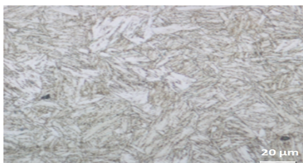
شکل ۲- ریزساختار فولاد مقاوم به سایش.
