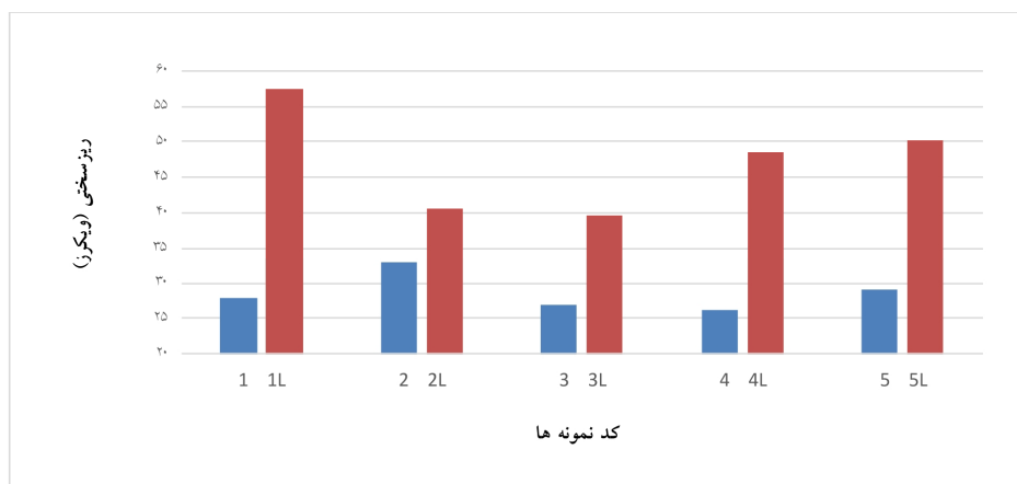
شکل 14- مقایسه مقدار سختی منطقه جوش در نمونه های جوشکاری شده با و بدون استفاده از لایه میانی AA7075 به روش اصطکاکی اغتشاشی.
