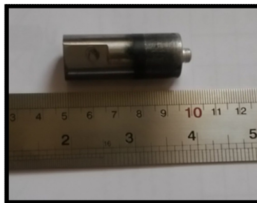
شکل 1- نمونه ابزار ساخته شده برای جوشکاری اصطکاکی اغتشاشی.
