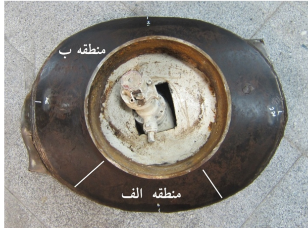
شکل 3- تکه پرتاب شده به محلی دور در اثر انفجار به همراه موقعیت قرارگیری نشان دهنده ی PIG و مناطق الف و ب
