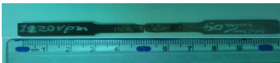
شکل ۱۰- تصویر نمونه و محل شکست آن پس از آزمون کشش
