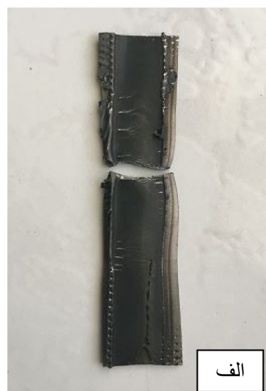
شکل ۵- الف) تصویر شکست نمونه جدا شده در راستای جوش (ب) نمودار نیرو- جابجایی نمونه ای با بیشترین استحکام
