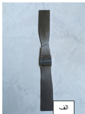
شکل ۶- الف) تصویر شکست نمونه جدا شده در راستای عمود بر خط جوش (ب) نمودار نیرو- جابجایی نمونه های جدا شده در راستای عمود بر خط جوش.
