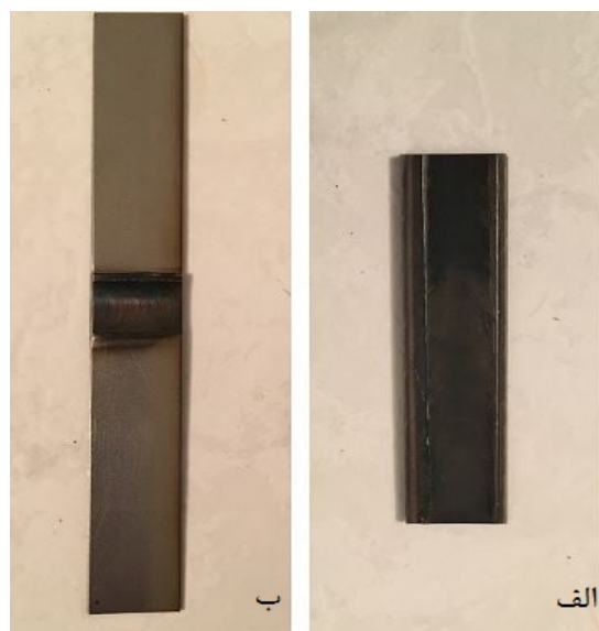
شکل ۴- نمونه های مورد استفاده در آزمایش کشش تک محور. (الف) در راستای جوش (ب) عمود بر راستای جوش
