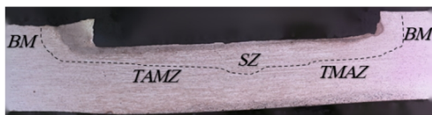
شکل 15- درشت ساختار نمونه ترمیم شده با شیار به عمق 2 میلیمتر.
