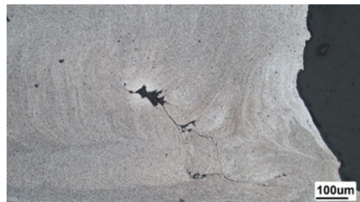
شکل 24- حفره‌های قابل مشاهده در نمونه 2 میلیمتری.
