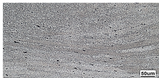
شکل 18- ریزساختار TMAZ در نمونه با شیار به عمق 1 میلی متر.
