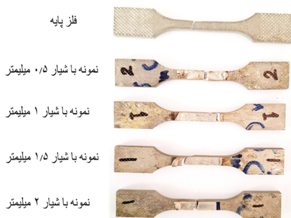
شکل 30- تصویر نمونه‌ها بعد از تست کشش.
