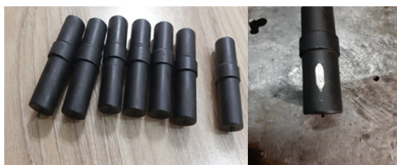
شکل 1- ابزارهای سخت‌کاری شده (52 راکول سی).
