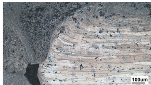
شکل 23- حفره‌های قابل مشاهده در نمونه 0/5 میلیمتری.
