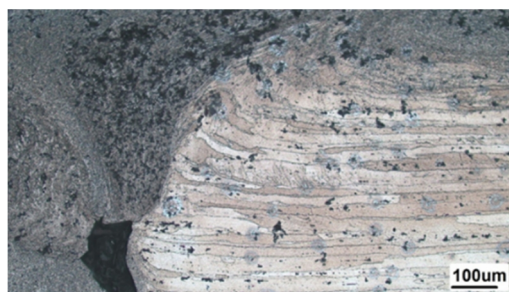
شکل 23- حفره‌های قابل مشاهده در نمونه 0.5 میلی‌متری.
