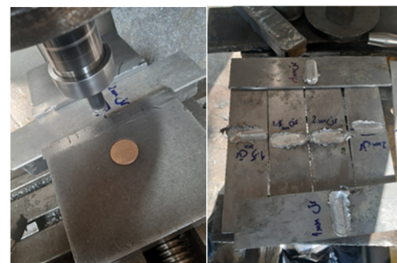
شکل 4- نحوه ترمیم ترک ورق آلومینیومی 7075.
