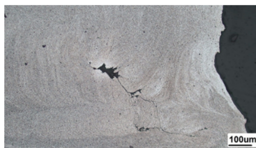
شکل 24- حفره‌های قابل مشاهده در نمونه 2 میلی‌متری.
