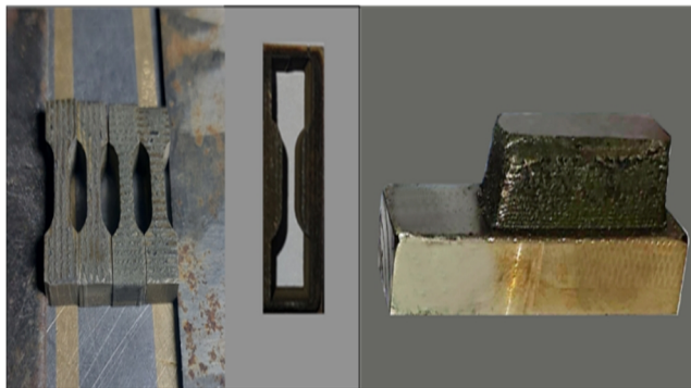
شکل 4- نمونه ساب‌سایز آزمون کشش
