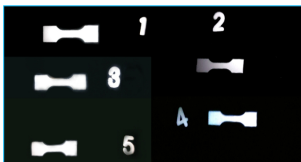
شکل 10- تصاویر رادیوگرافی نمونه های تست کشش
