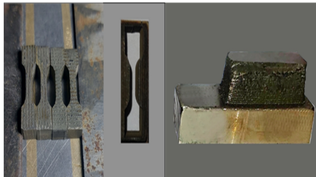
شکل 4- نمونه ساب‌سایز آزمون کشش
