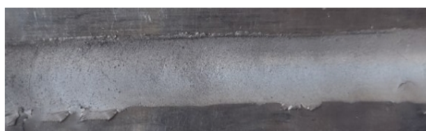
شکل 2- مورفولوژی سطحی جوشکاری اصطکاکی.
