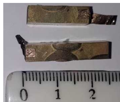
شکل 6- نمونه های جوشکاری شده پس از برش وایرکات.
