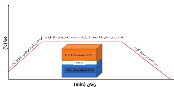
شکل 3- طرح‌واره فرایند پیونددهی قطعات.
