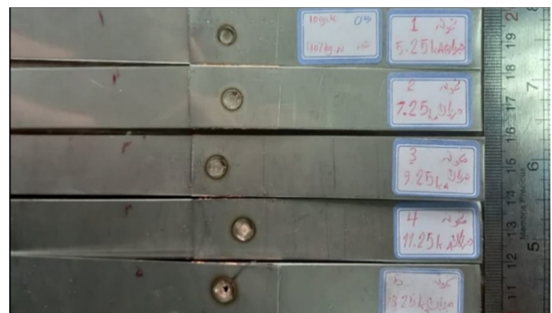
شکل 2- نمونه‌های جوشکاری شده با لایه واسط.
