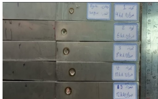
شکل 3- نمونه‌های جوشکاری شده بدون لایه واسط.
