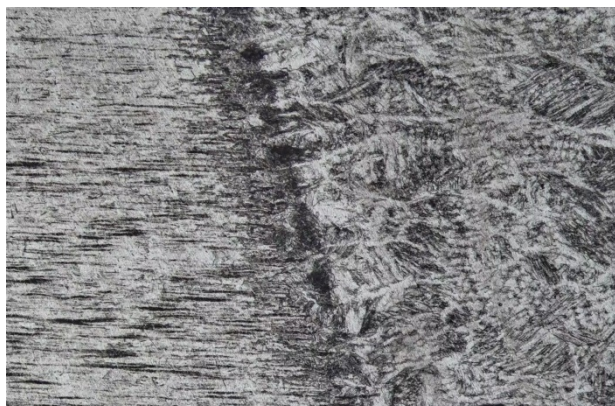
شکل 11 - ریزساختار فلز جوش و ناحیه متأثر از حرارت در جوشکاری تیگ فعال با اعمال امواج فراصوت
