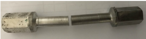
شکل 7- تصویر نمونه‌ی M4 پس از انجام آزمون پیچش.
