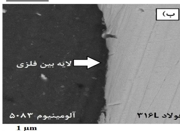
شکل 11- تصویر میکروسکوپی الکترونی روبشی الف- منطقه اغتشاشی نمونه جوشکاری شده با سرعت چرخش 250 دور در دقیقه و سرعت پیشروی 25 میلی متر بر دقیقه و ب- منطقه مشخص شده با دایره قرمز در شکل الف با بزرگنمایی بیشتر.
