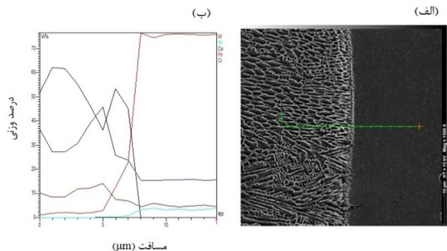
شکل 8- تصویر میکروسکوپی الکترونی رویشی از منطقه متاثر از حرارت در فولاد زنگ‌زن 17-4PH.
