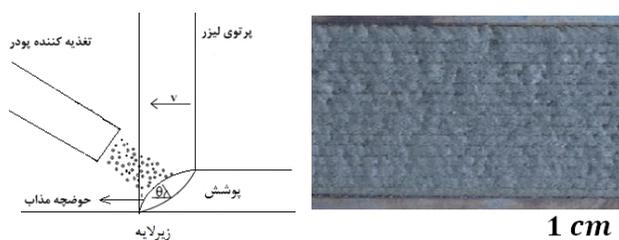
شکل 3- الف- طرح‌واره ای از روش کاری لیزری با تزریق پودر و ب- تصویر روش تک‌لایه انجام‌شده در این پژوهش.
