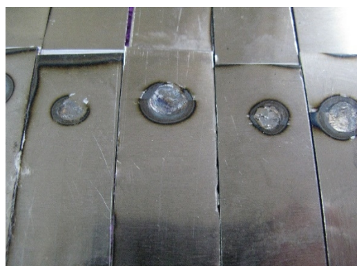
شکل 3- نمونه‌های جوشکاری شده با روش جوشکاری مقاومتی نقطه‌ای.
