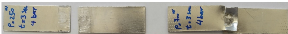
شکل 7- نمونه‌ای از جدا شدن ورق‌ها.
