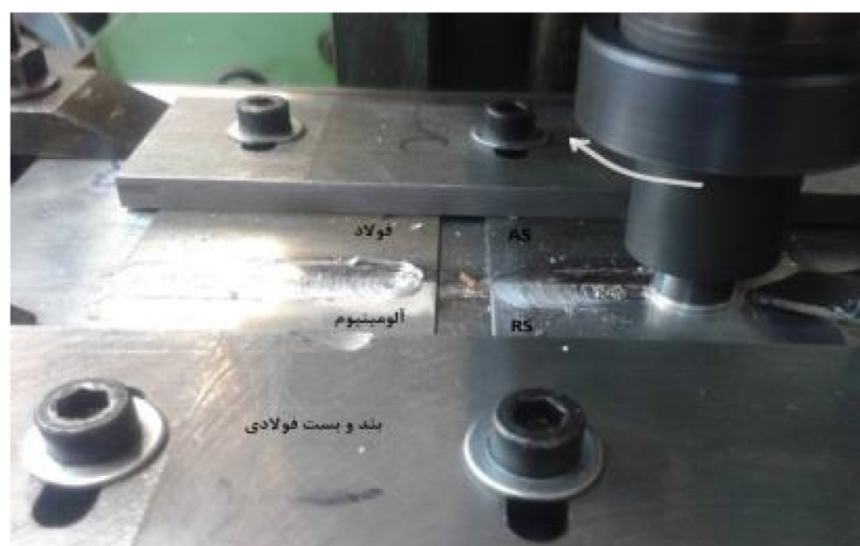
شکل 2- فرایند جوشکاری اصطکاکی همزدنی ورق آلومینیم به فولاد و سامانه بند و بست فولادی در این تحقیق.
